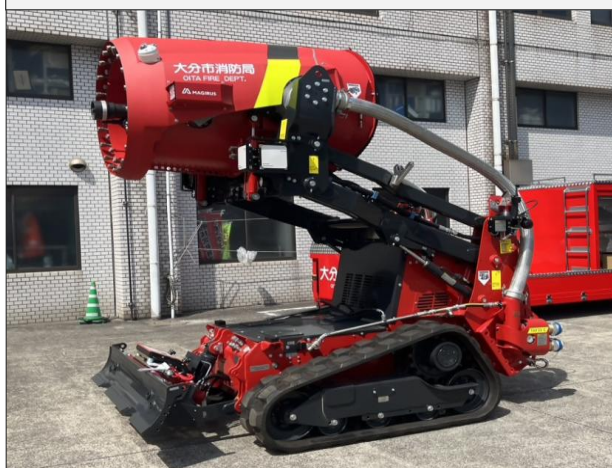
無人走行放水ロボット
