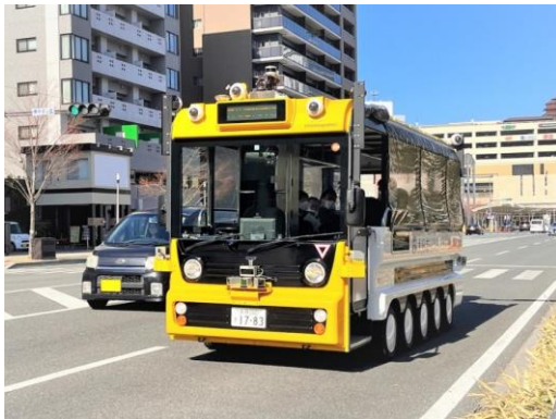
図 大分いこいの道周辺を遠隔監視・操作で運行する自動運転車両
