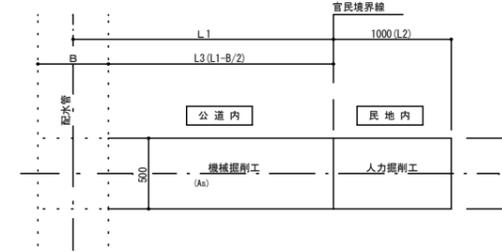
給水管掘削断面図
