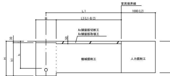
給水管埋戻断面図
