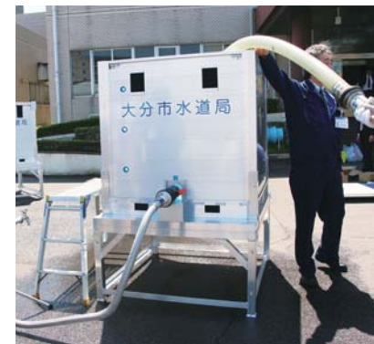
応急給水資機材（仮設給水コンテナ）
