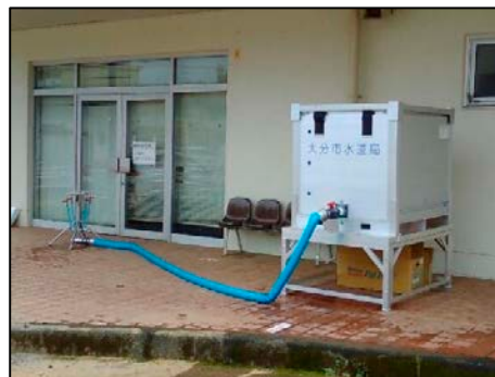
避難所に設置する応急給水資機材
