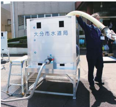
応急給水資機材（仮設給水コンテナ）
