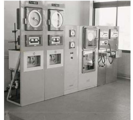
管理計測機 （左からアルカリ度計、pH計、濁度計）
