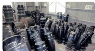
応急復旧資機材（曲管）
