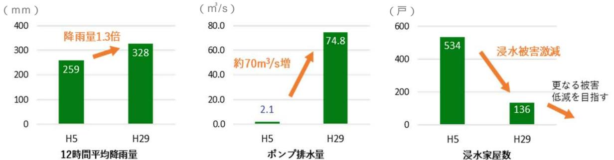
平成5年度の台風により市内全域で大きな被害を受けたことから、雨水排水ポンプ場を整備し、特に大野川流域では、排水可能量を $2.1\text{m}^3/\text{s}$ から $74.8\text{m}^3/\text{s}$ に向上させています。これにより平成29年の台風時には、平成5年度の1.3倍の降雨量がありましたが、浸水家屋数を激減させることができました。
