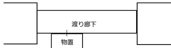
イ 渡り廊下の有効幅員は、接続される一方又は双方の建築物の主要構造部が木造である場合は3m未満、その他の場合は6m未満であること。ただし、接続される双方の建築物の主要構造部が耐火構造で、渡り廊下が、不燃材料で造られた吹き抜け等の開放式である場合、この限りでない。(図6参照)
