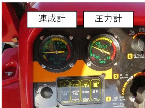
**圧力計** ポンプ吐水口側配管に取付けられており、放口側の圧力をMPaで示す。
