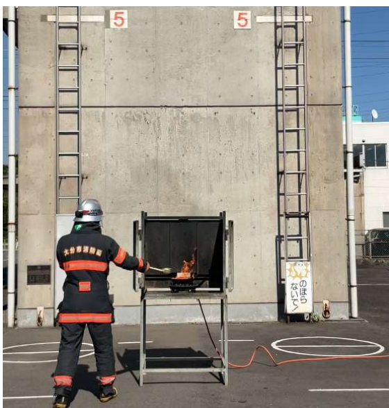
発火したてんぷら油に水をかける燃焼実験の様子(消防局予防課)
