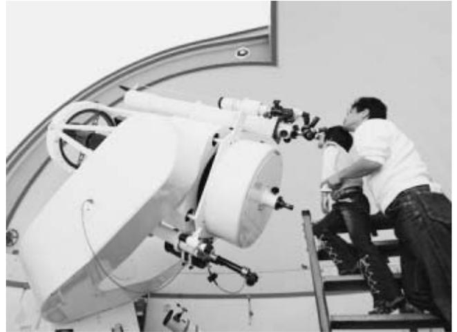
60cmニュートン・カセグレン式反射望遠鏡
