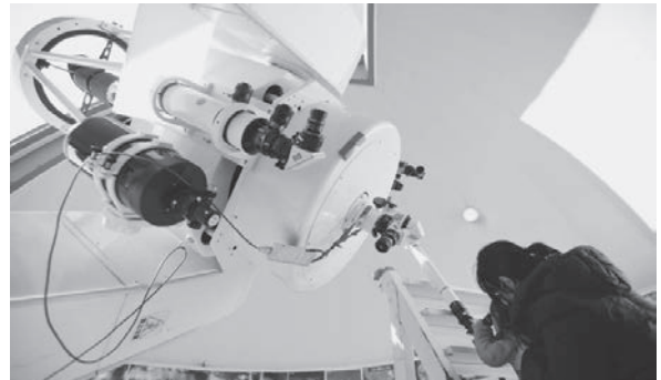
60cmニュートン・カセグレン式反射望遠鏡 (望遠鏡で天体観察をする親子)
