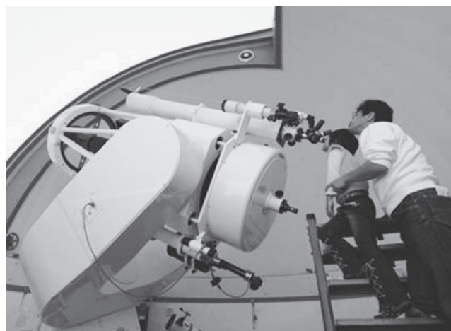
60cmニュートン・カセグレン式反射望遠鏡 (望遠鏡で天体観察をする親子)
