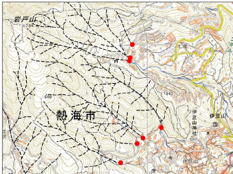
図 2-14 溪床勾配10度以上を呈す一連の谷地形の中心の抽出例 『盛土等防災マニュアルの改正概要と考え方』(国土交通省)
