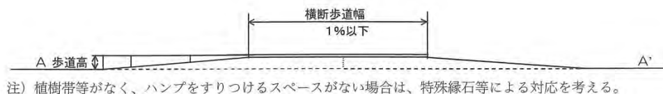
図 - スムース横断歩道の横断図面
