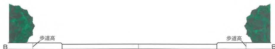
図 - スムース横断歩道の縦断図面
