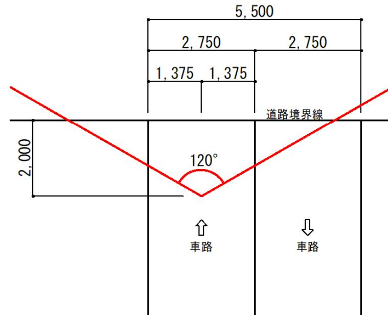
駐車場出口付近の構造は、道路境界線から2m後退した車路の中心線上1.4mの高さにおいて、左右各60度以上の範囲内の歩行者の存在を確認できる視界を確保すること
