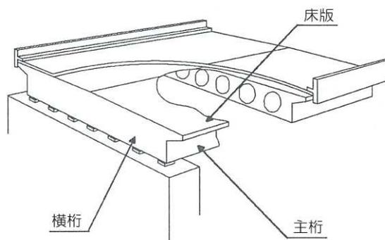
PC箱桁、RC箱桁
