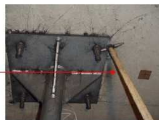
打音検査の例
