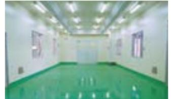
加工現場にクラス10000とクラス30000の清浄度が異なる2種類のクリーンルームを設置している。材料搬入から溶接、組立まで一貫して厳しい条件で製作できる。
