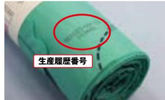
ごみ袋 1枚毎に生産履歴番号を印字し、更に製造工程を24時間10年間ビデオ録画するなど、生産履歴の記録を徹底している。不具合が生じたときの早期の原因究明と迅速な対応が可能だ。
