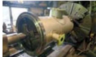
高い耐食性が特徴で原子力関連や化学プラントに使われるハステロイ。治具製作に加え長年の経験で培った切削ノウハウによって難削材の加工を実現している。
