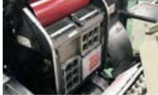
活版印刷機は紙のセット位置や機械を動かすスピード、紙の特性に合わせて加圧など多くのノウハウが求められる。機械の性能を熟知した職人がお客の要望を忠実に具現する。
