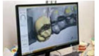
患者負担が小さい口腔内スキャンに対応した3DCADシステムを導入している。石ころの印象変形がなく、精度の高いオーダー品を短納期で納品できる。価格や品質面で高い競争力を持つ。
