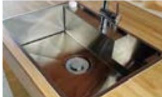
高い技術を要するシンクの製作を得意とする。1枚の板から折り曲げ加工と溶接を行い、R部分はハンマーでたたいて型を整える。加工するときには傷を付けてはいけないという難しさがある。
