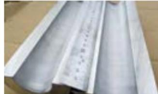
電力会社向けに電線の束を収納する筒状の金属部品を試作した。同部品には高難度の技術を要する内径ローレット加工を採用。筒の内部に凹凸状の加工を施すことで滑り止めの機能を持たせている。
