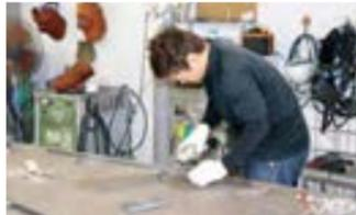
ほぼ全ての製作を自社で行っている。材料の切断から曲げ加工、溶接、仕上げまでを自社で一貫対応する。小ロット、短納期に対応することで顧客の支持を得ている。
