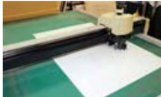
パソコンで作製した設計図通りに厚紙を型抜きするサンプルカッターという機械を導入している。厚い紙に印刷できる設備なども充実しており、設備を持たない印刷会社からの依頼も多いという。
