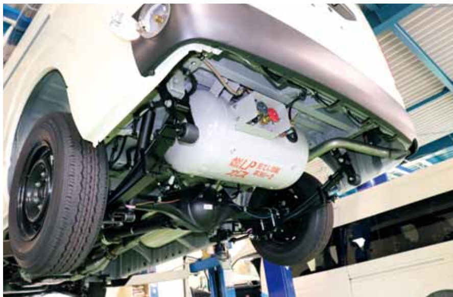
LPG デュエルフューエル車の製造現場
