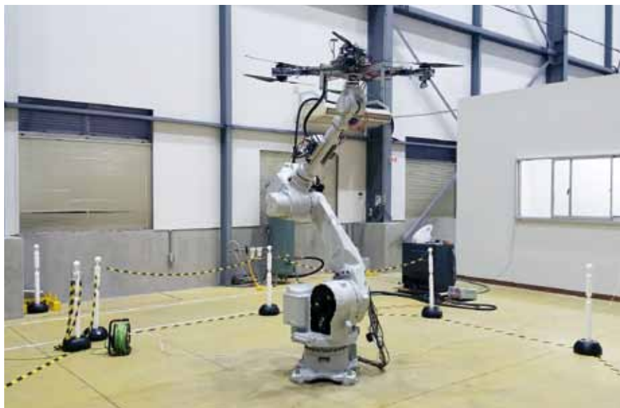
大分県産業科学技術センターと共同開発した「ドローンアナライザー」
