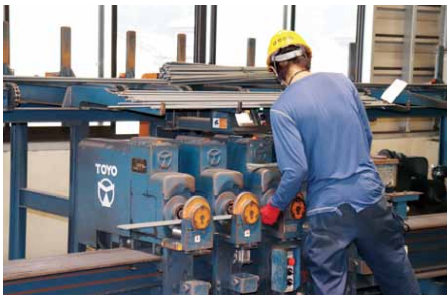
棒状の鉄筋を切断、曲げ加工する現場
