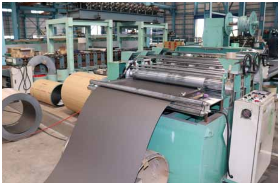
ロール状の金属板を指定長さに切断しロール成型加工
