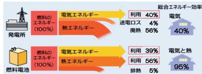
図 燃料電池のエネルギー効率
