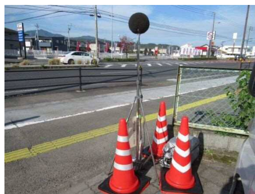
道路騒音測定の様子
