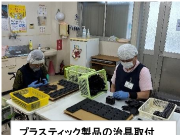
プラスチック製品の治具取付
