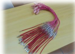
【ヒューズ管作業】 ・ヒューズ管の検品・チューブ差し
