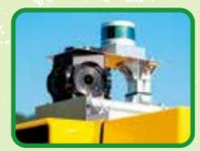
バスの天井には、自動運転用センサーカメラやGPSが搭載されています(自動運転時のみ使用します)。
