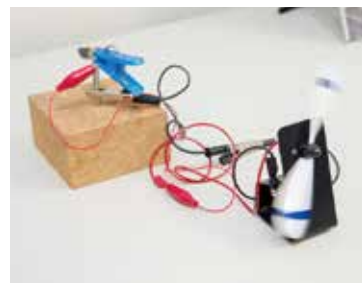
竹を原料としてできた電池で回転するプロペラ
