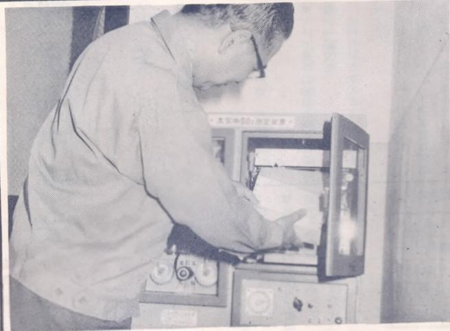
写真=新しく設置された亜硫酸ガス測定装置(三佐小)
