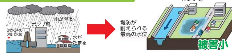
河川の水位上昇を抑制するため、ポンプを一時的に停止し、内水排水を規制します。
