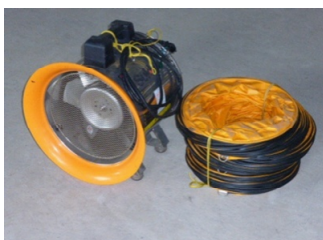
可搬式送風機・ダクト
