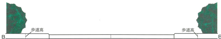
図 - スムース横断歩道の縦断面図
