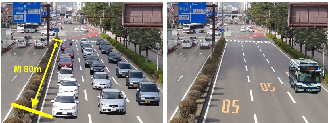
▲同一人員の移動に要する自家用車とバスの占有面積（イメージ） 自動車：現在の平均乗車人員の1.23人が1台に乗っていると想定 バス：全員が座席に座り、27人が1台に乗っていると想定
