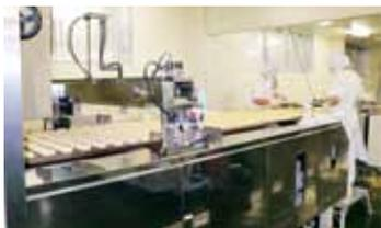
5年前に工場を増設した際に包餡(あん)機と焼成機を新たに導入した。衛生管理意識の高まりもあり、従来手作業で行っていた作業を機械で行うなど、菓子製造工程の機械化を進めている。
