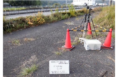
騒音（振動）調査状況
