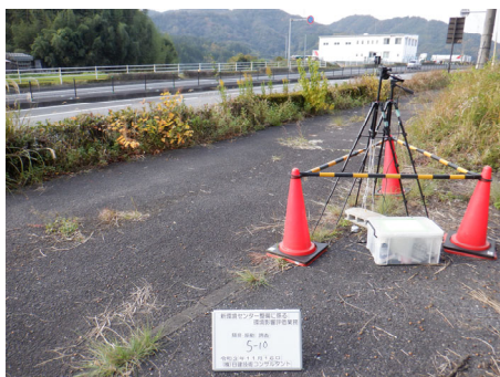
調査状況（環境騒音・振動、低周波音、道路交通騒音・振動）
