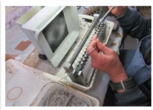
ヒューズのはんだ付け作業
