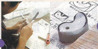
石に描かれている線に沿って、周りをやすりで削り、角を斜めに丸くしていきます。
