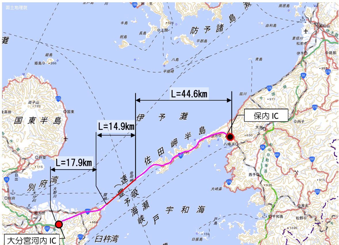
図 2-25. 橋梁（道路供用）計画延長根拠図
